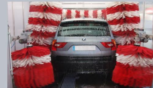
In installazioni a partire da 12,5 metri, si possono installare due spazzole verticali aggiuntive per offrire un valore aggiunto all'installazione e una maggiore qualità di lavaggio.
