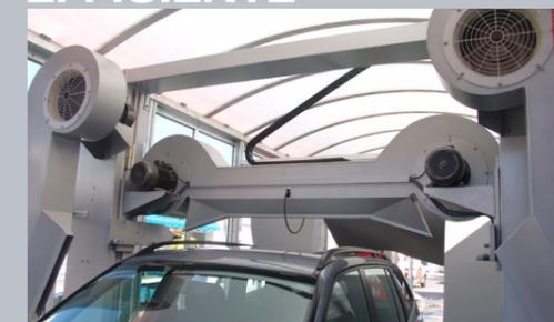
Il modulo d'asciugatura è composto da 4 turboventilatori con una potenza di 4 Kw ciascuno. Lavorando a basse rivoluzioni (1500 rpm) e un'elevata portata d'aria per migliorare il rendimento. L'asciugatura orizzontale con il suo particolare disegno 3D offre una qualità d'asciugatura eccezionale in qualsiasi tipo di veicoli.
