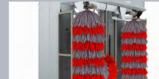
Schermi in metacrilato e rinforzi in alluminio che, con un design sicuro e pratico, sono integrati nella struttura dell'impianto. È un'opzione raccomandata per evitare gli schizzi nella fase di lavaggio.
