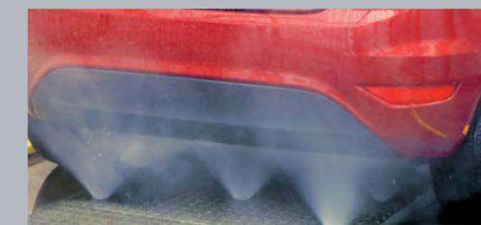
Si può scegliere tra lavaggio sottoscocca fisso 10 bar, 90 L/min, oscillante 15 bar, 120 L/min o a settori 15 bar, 120 L/min.
