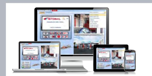
Comunica gli impianti con **IW-MANAGER**, software per la gestione e il controllo integrale sia in connessione locale che remota. Disponibile anche lo Screen Access, software di accesso remoto al posto di comando per la relativa diagnosi.
