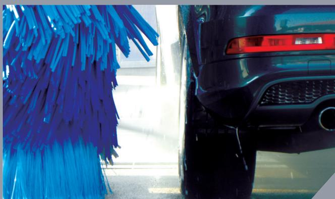
Come complemento ideale per le alte pressioni esistono vari tipi di lavar ruote per incidere sul lavaggio dei cerchi: Lavar ruote a disco normale o doppio estensibile, con alta pressione integrata a 4 o 8 ugelli o lavar ruote ad alta pressione rotante con 6 ugelli.
